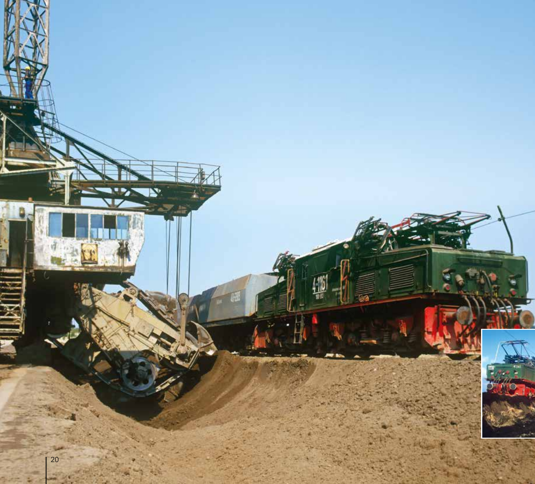
Grubenlokomotive EL 2 mit Abraumzug am Absetzer As 1600-1025 im Sanierungstagesbau Golpa-Nord, 1994
