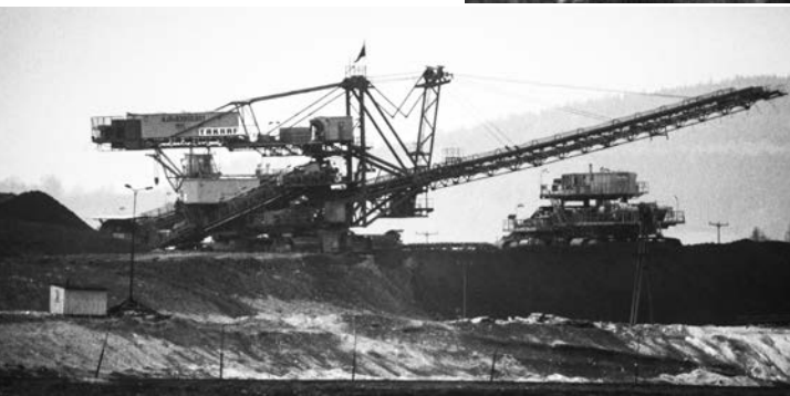
Absetzer A_Rs-B 3500.60-1111 auf der Halde des Tagebaus Olbersdorf während des Auslaufbetriebs, 1990
