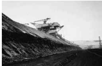
Eimerkettenbagger im Abraumbetrieb, 1979
