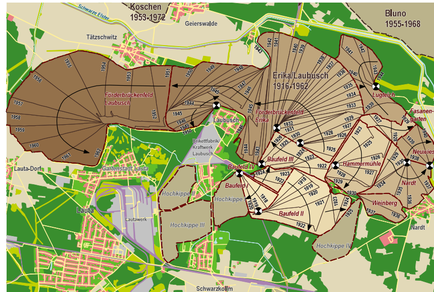
Tagebau Erika/Laubusch: (1916-1962) Landinanspruchnahme: 2.316 ha (gesamter Tagebau einschließlich Hochkippen)
